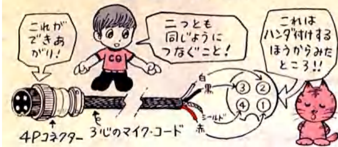
第6図 接続コードの作り方
