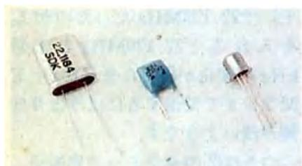
写真1 左より、水晶発振子、セラミック発振子、リチウムタンタレート振動子
