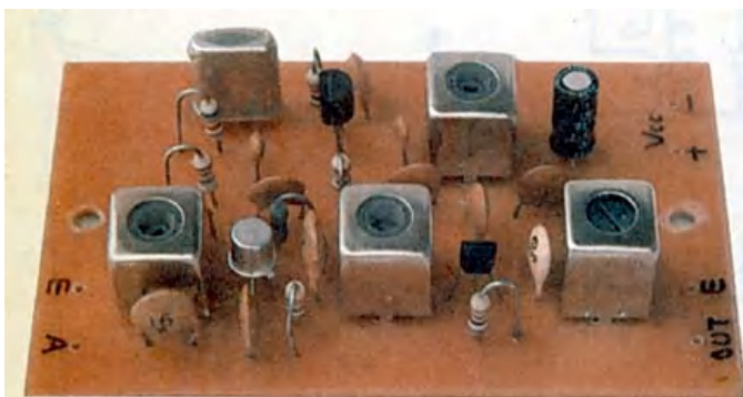
写真1 50MHz帯用のクリコンのプリント板
