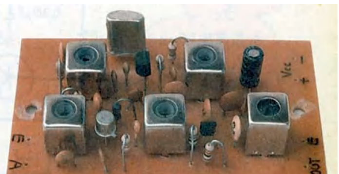
写真2 144MHz帯用のクリコンのプリント板
