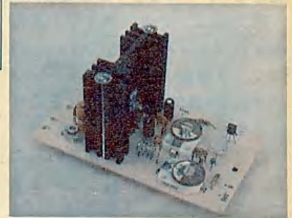
リニアアンプのプリント基板. 放熱器がないもの(上)と放熱器が付いているもの(左)
